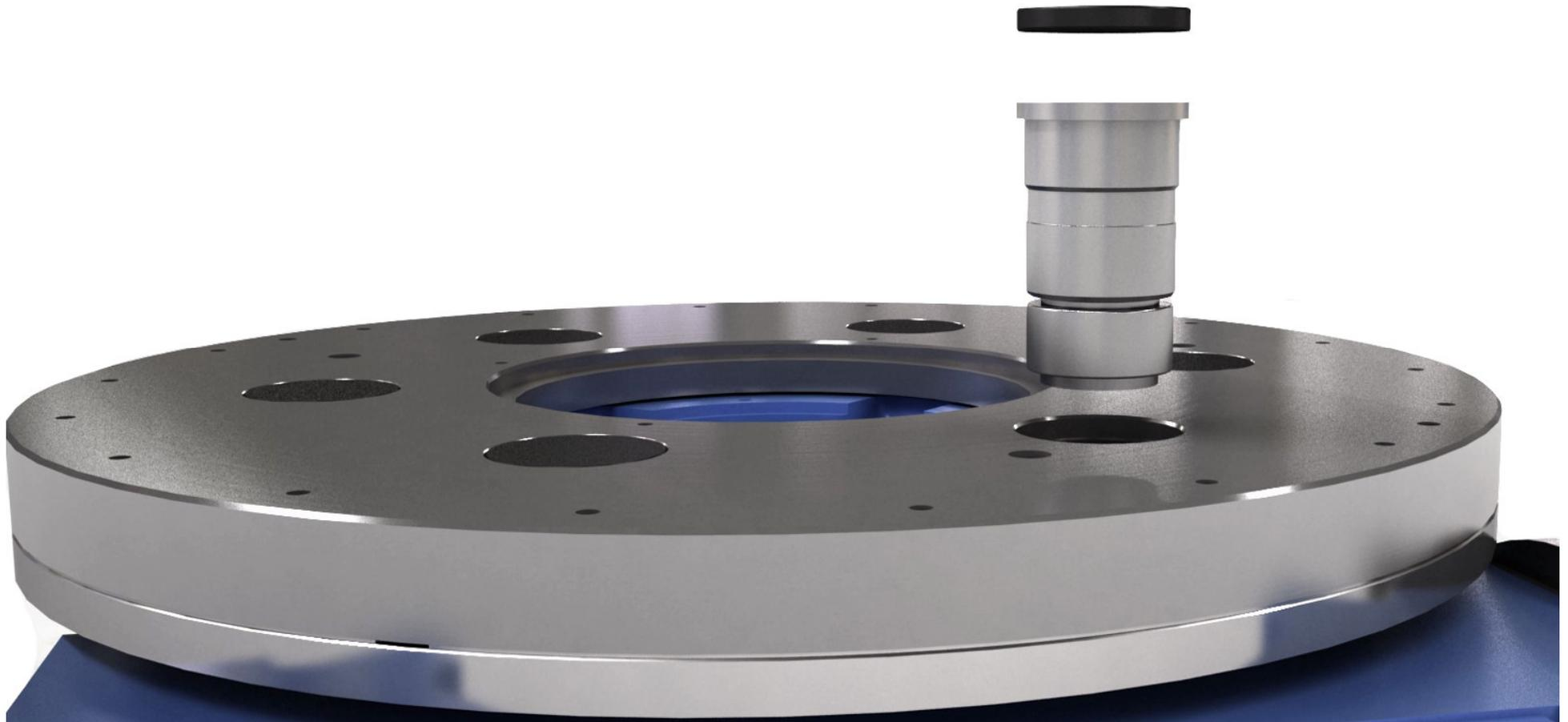
Die Überlastung eines Drehtisches z. B. durch Crash oder Fehlbedienung kann zu einer Beschädigung des Antriebsbolzens führen.
