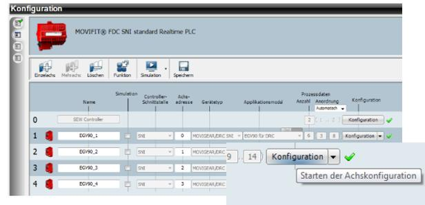
Die Inbetriebnahme des DRC-Motors erfolgt über die Achskonfiguration.
