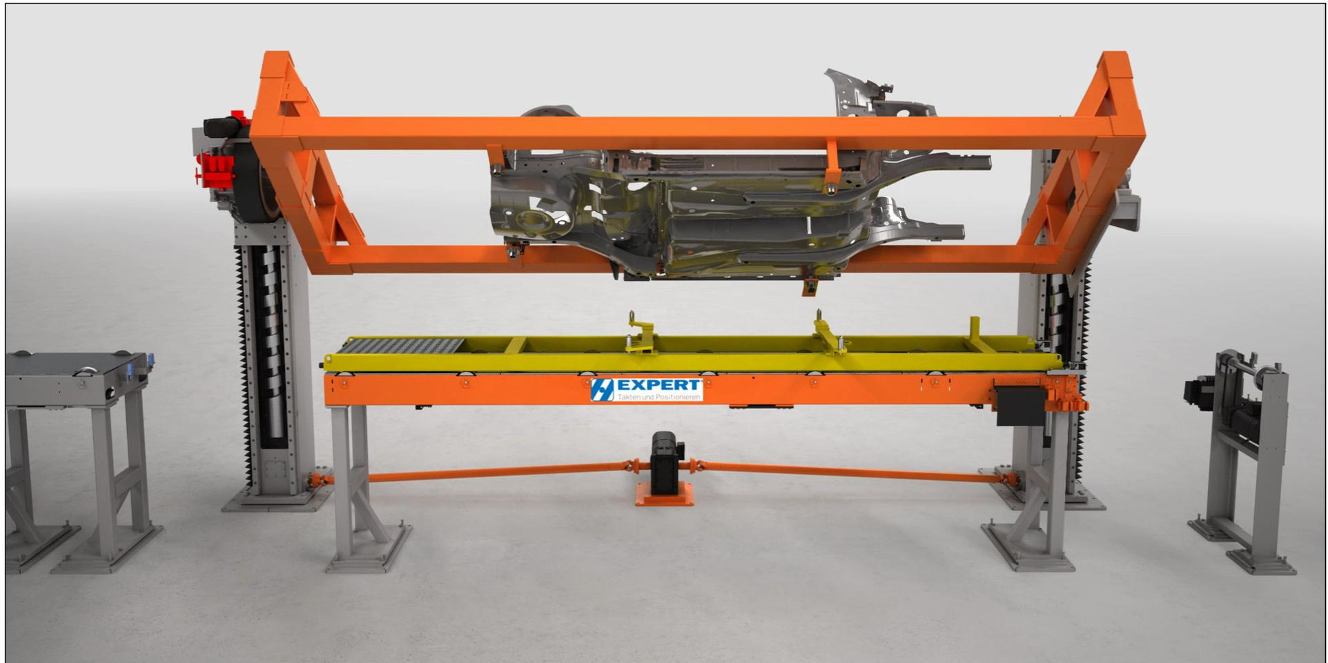
Präzises Bauteilhandling in der oberen Bearbeitungsposition bei maximaler Flexibilität durch Verwendung von Servo-Drehtischen der EDH-Serie.
