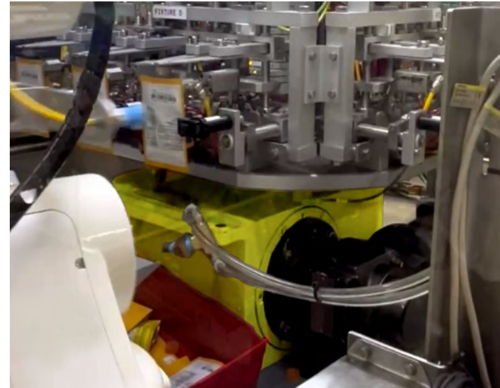
EXPERT Trommelantrieb mit Wartungsabsteckung
