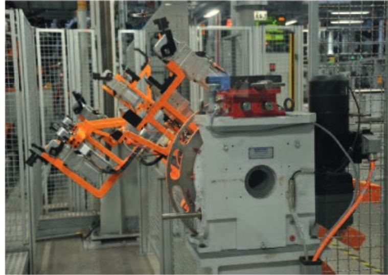
EXPERT Trommelantrieb mit Wartungsabsteckung
